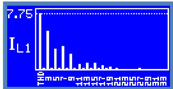
Bu ekran sadece bir fazın akımının, 2-33 arası ve THD değerinin spektrum olarak sunulduğu sayfadır. THD yüzdesi sol üst köşede yazar ve spektrumdaki diğer harmonikler bununla orantılı olarak bar grafiği şeklinde gösterilir.
