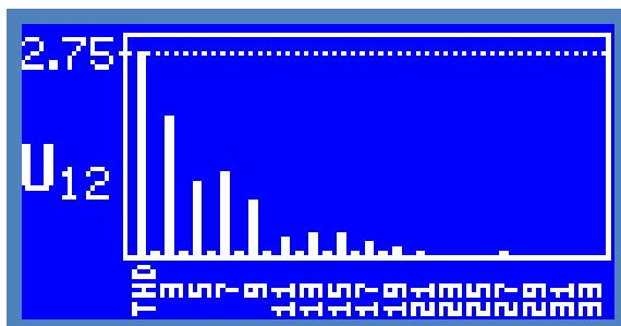
Bu ekran sadece bir faz-faz geriliminin 2-33 arası ve THD değerinin spektrum olarak sunulduğu sayfadır. THD yüzdesi sol üst köşede yazar ve spektrumdaki diğer harmonikler bununla orantılı olarak bar grafiği şeklinde gösterilir.
