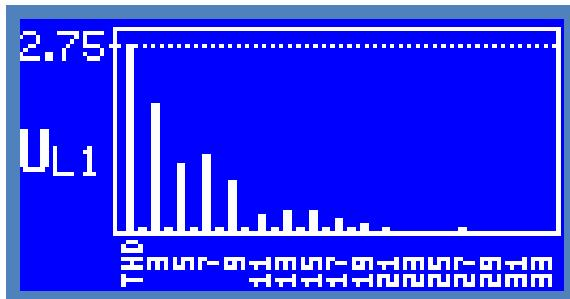
Bu ekran sadece bir fazın 2-33 arası ve THD değerinin spektrum olarak sunulduğu sayfadır. THD yüzdesi sol üst köşede yazar ve spektrumdaki diğer harmonikler bununla orantılı olarak bar grafiği şeklinde gösterilir.
